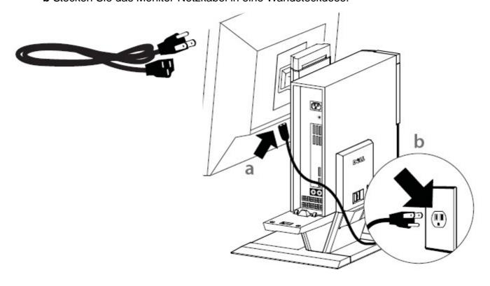
8 a Schließen Sie das System-Netzkabel am Computer an.
