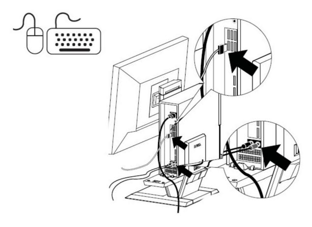
10 Führen Sie die Anschluss- und die Netzkabel durch die Kabelklammer auf der Rückseite des Komplett-Ständers.
