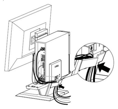
11 Schieben Sie die Kabelabdeckung darüber und nach unten, um sie am Computer-Chassis zu befestigen.
